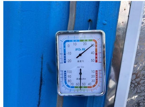
熱危害防制-工地溫濕度測量
